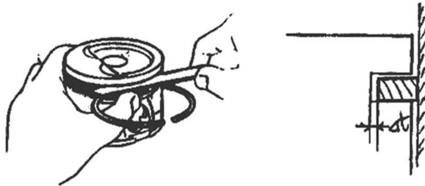
Hình 8-10 Kiểm tra khe hở cạnh
